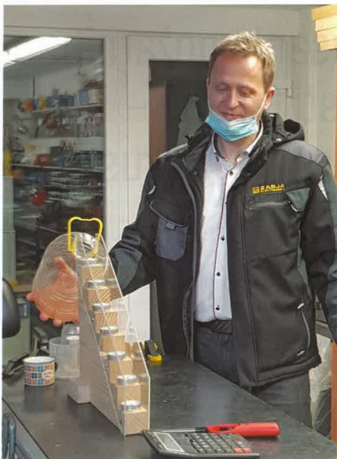
Slika 6: Demonstracija gašenja s plinom NOVEC 1230
