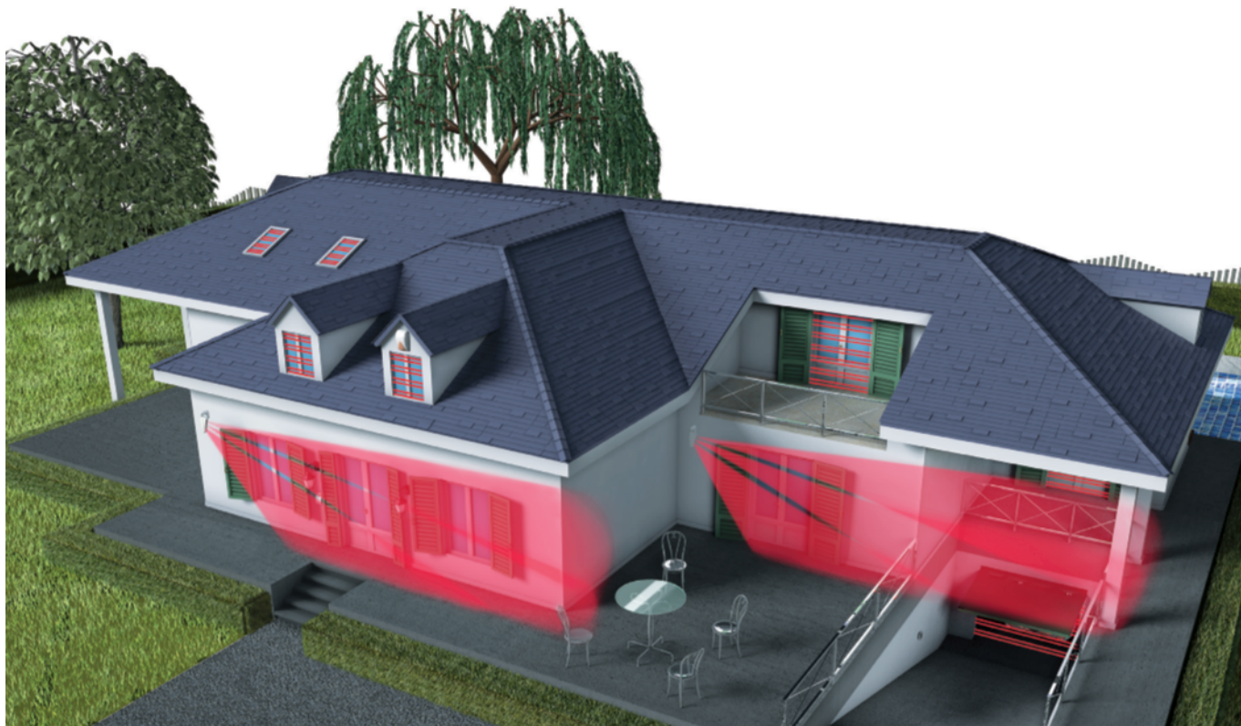
Zunanje varovanje objekta z javljalniki TRIRED in WIN(DOOR)BEAMS
